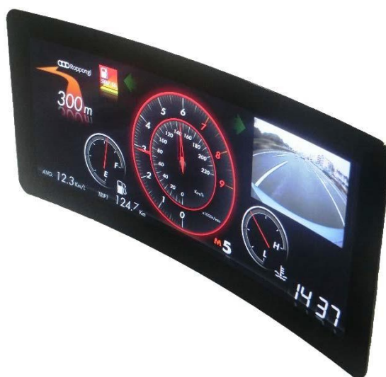
Цветной TFT-LCD-модуль с изогнутым экраном, изготовленный по новой технологии (радиус кривизны составляет 800 мм)
